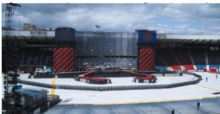
Figura n. 05: Setorização com barreiras antiesmagamento próximas ao palco Fonte: Institution of Structural Engineers (United Kingdom, 2007)
