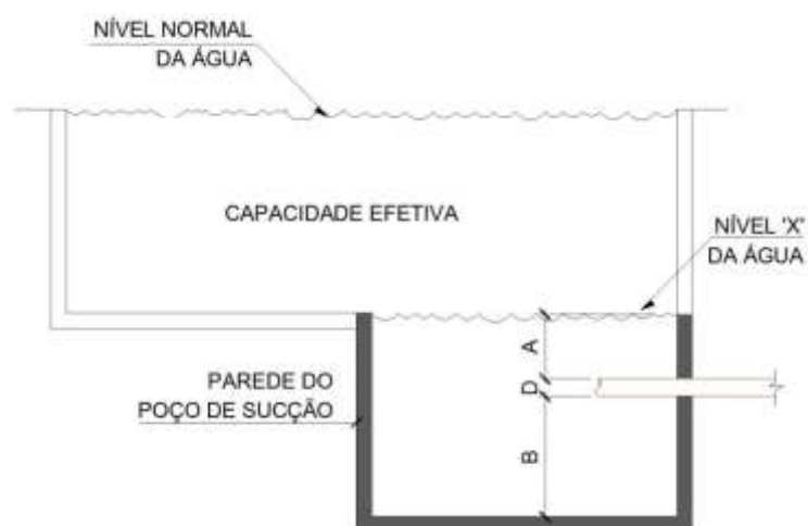
Figura B.1 - Tomada superior de sucção para bomba principal
