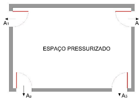
Figura 1 – Trajetórias de escape do ar em paralelo
