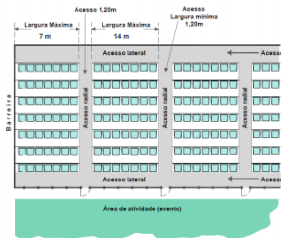
Figura H.2.2 - Arquibancada provisória
