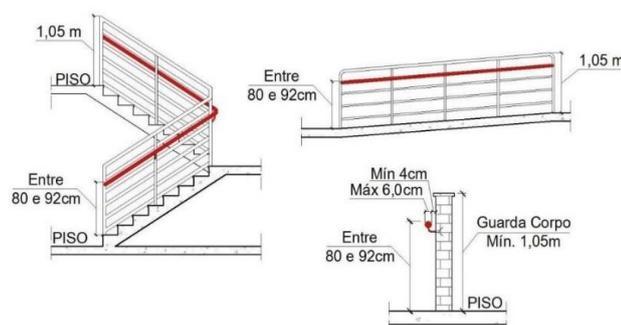
Figura 18 – Dimensões de guardas e corrimãos
