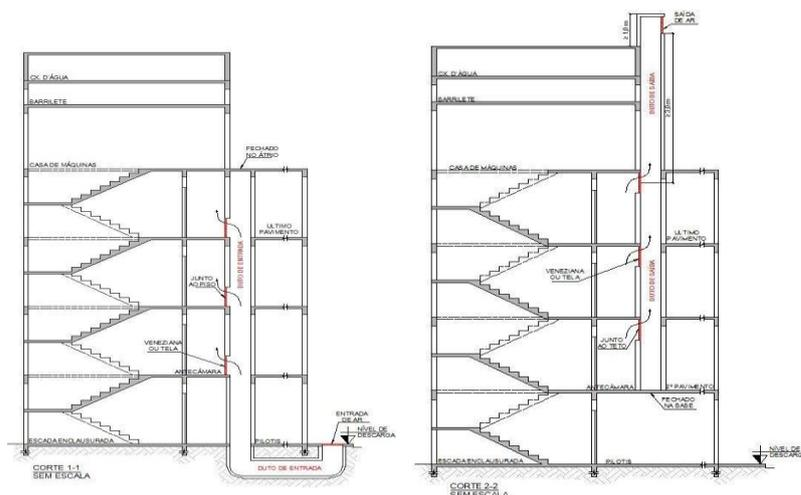
**Figura 13** – Antecâmaras e Duto de ar – Desenho esquemático
