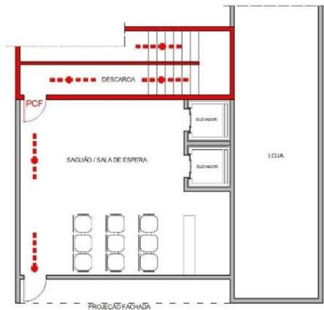
**Figura 22** – Descarga através de hall térreo não enclausurado
