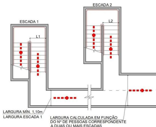
**Figura 23** – Dimensionamento de corredores de descarga
