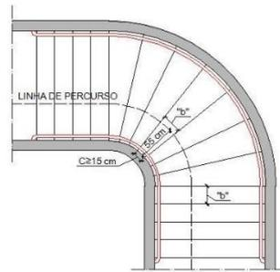
**Figura 6** – Escada com lanço misto e degraus balanceados
