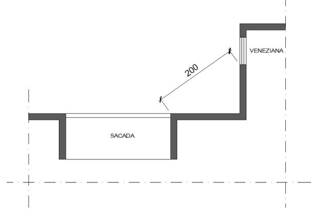
**Figura 11.g** - Distância entre a veneziana da escada EP e qualquer outro tipo de abertura em planos distintos.
