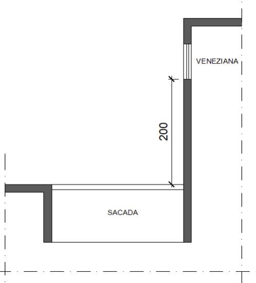
**Figura 11.f** - Distância entre a veneziana da escada EP e qualquer outro tipo de abertura em planos distintos.
