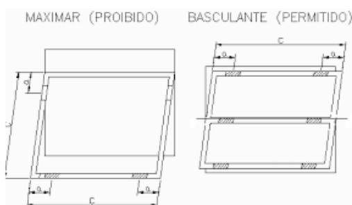
**Figura 10.b** – Janela da escada enclausurada protegida
