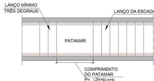
**Figura 7** – Lanço mínimo e comprimento dos patamares
