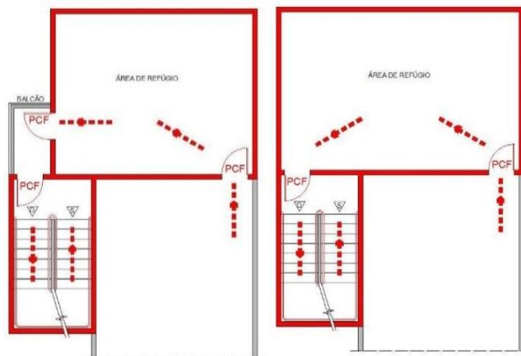
**Figura 21** – Desenho esquemático da área de refúgio
