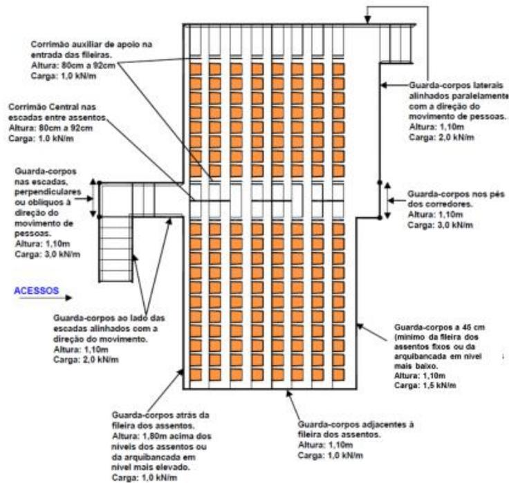
**Figura H.2.4:** Resistência mecânica das barreiras da arquibancada
