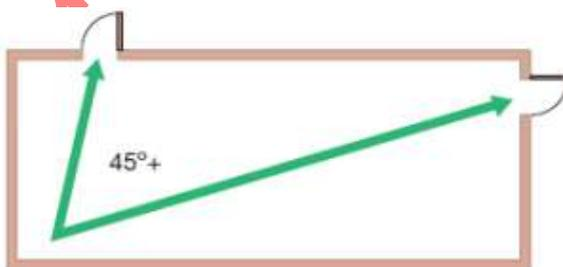
**Figura A.2.3.2:** distância entre aberturas de saídas de emergência
