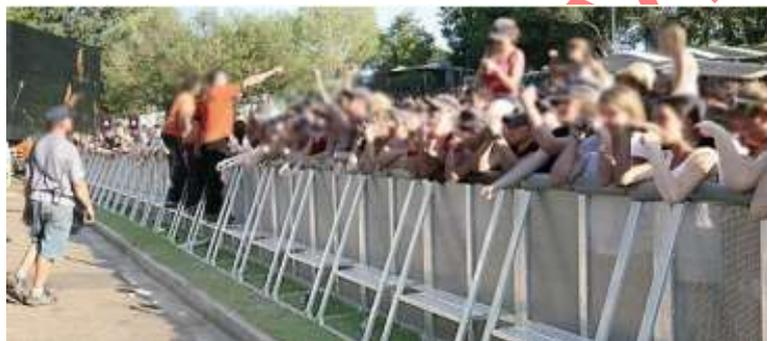
**Figura H.5 b:** Modelo de barreiras antiesmagamento com plataformas de apoio
