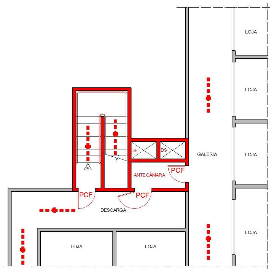
Figura 24 - Acesso de galeria comercial à descarga
