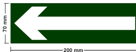
Figura 2 – Detalhe da sinalização tipo C-1
